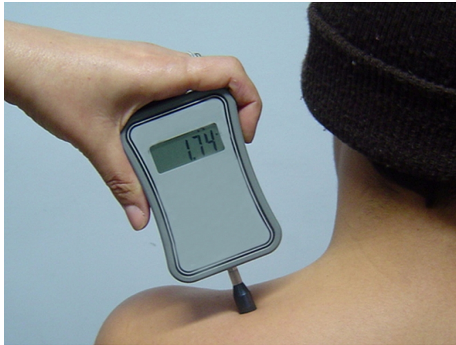
Figura 2. Algômetro digital de pressão utilizado no trabalho, marca Wagner Instruments ®, modelo FDI.
